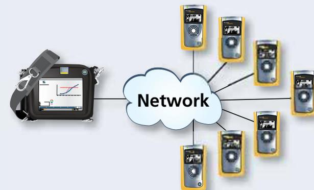
Тестирование с передачей данных с одного местоположения MetroScore на несколько устройств LinkReflector в поле действия
