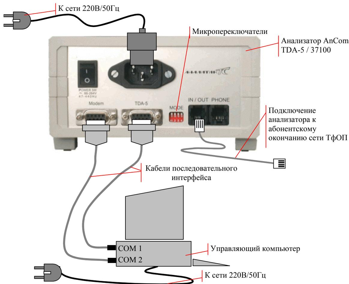
Рисунок 2. Схема соединения аппаратных средств AnCom TDA-5 / 37100
