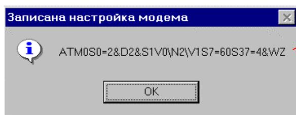
Строка параметров исходной настройки, завершающаяся командами записи и считывания энергонезависимой памяти (&WZ)
