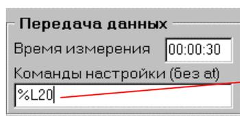
Последовательность команд настройки модема при соединении на скорости 2400 бит/с
