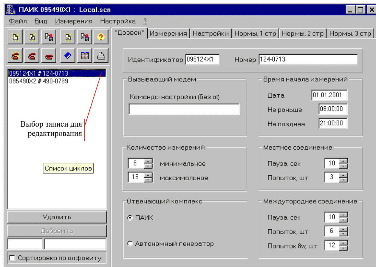
Рисунок 9. Редактирование параметров цикла измерений.
