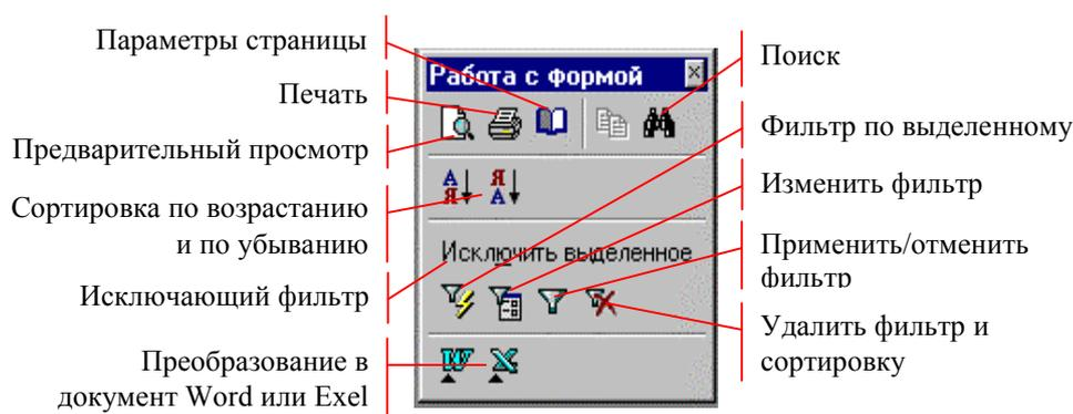
Рисунок 61. Панель "Работа с формой" (незакреплённое положение)
