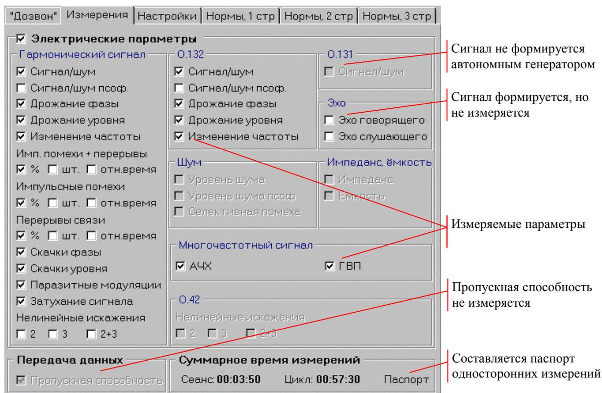
Рисунок 26. Выбор параметров при измерениях с автономным генератором
