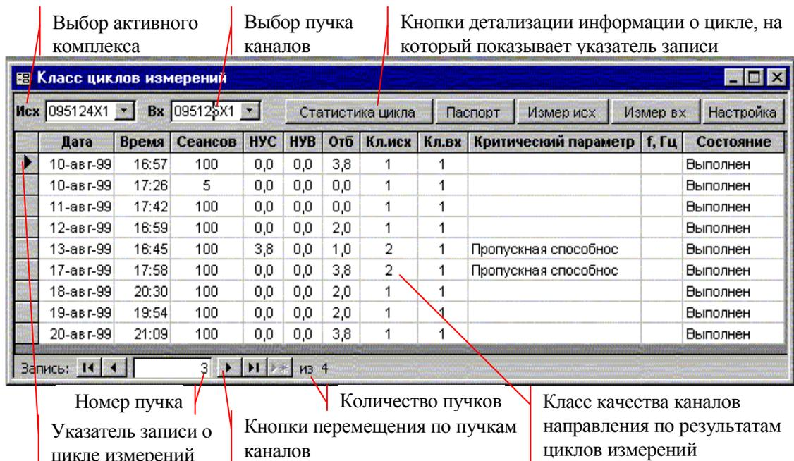
Рисунок 51. Форма "Класс циклов измерений" - режим экранной формы
