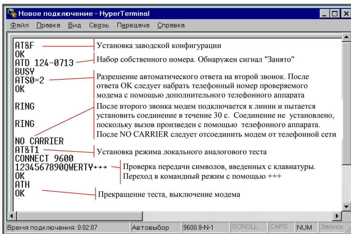
Рисунок 5. Проверка модема с помощью программы HyperTerminal
