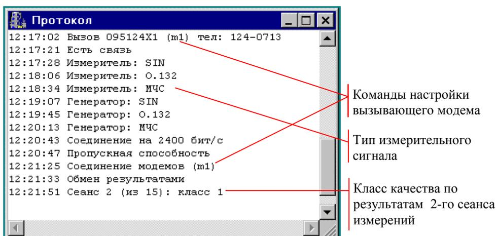
Рисунок 31. Окно протокола измерений
