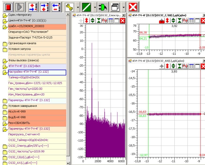
Автопрограмма **15**, поднимая уровень на входе, выводит канал ТЧ на границу перегрузки.
