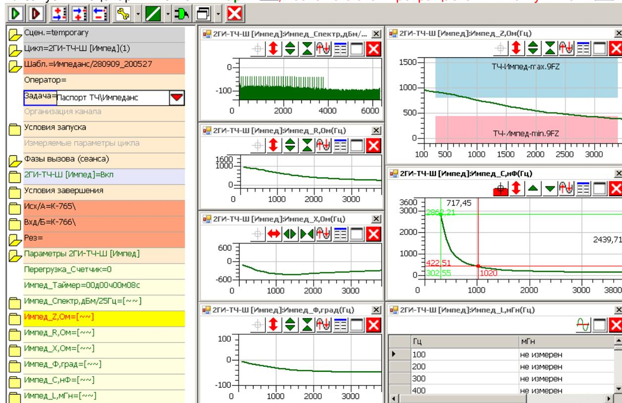
При измерении импеданса следует подключить измеряемый 2-полюсник (вход канала ТЧ) к разъему
