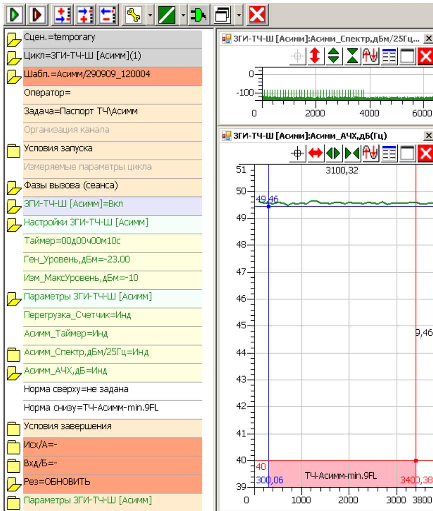
В данном примере отражено текущее состояние анализатора после измерения затухания асимметрии:
