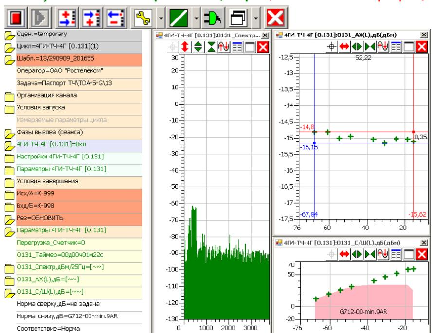
Автопрограммы 13 и 14 отличаются только диапазоном уровней псевдощумового сигнала с полосой 350...550 Гц.
