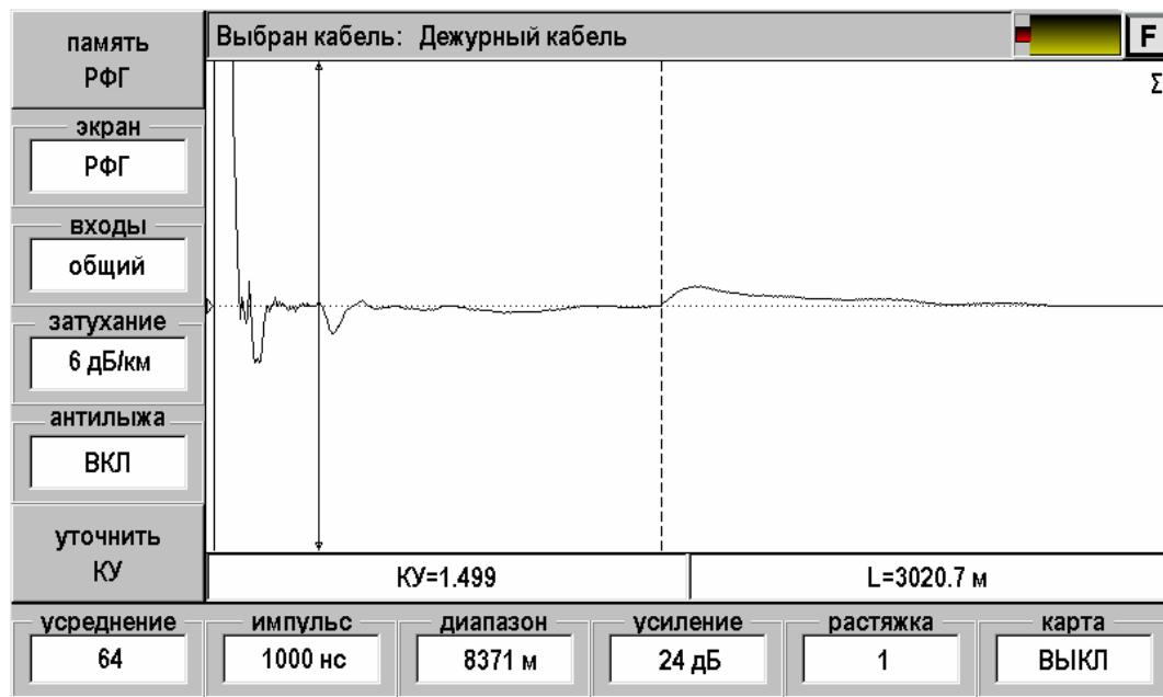
Вид рефлектометрии с исправленной «лыжей» принципиально лучше. Исчезла мертвава область после зондирующаго импульса. Слабо различимый дефект кабеля теперь может быть четко локализован.
