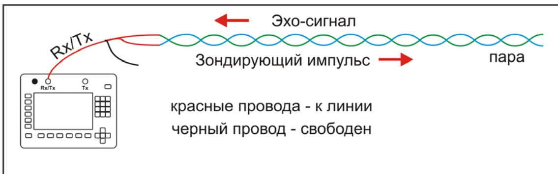
При работе с раздельными входами подключите прибор к кабелю в соответствии со схемой:
