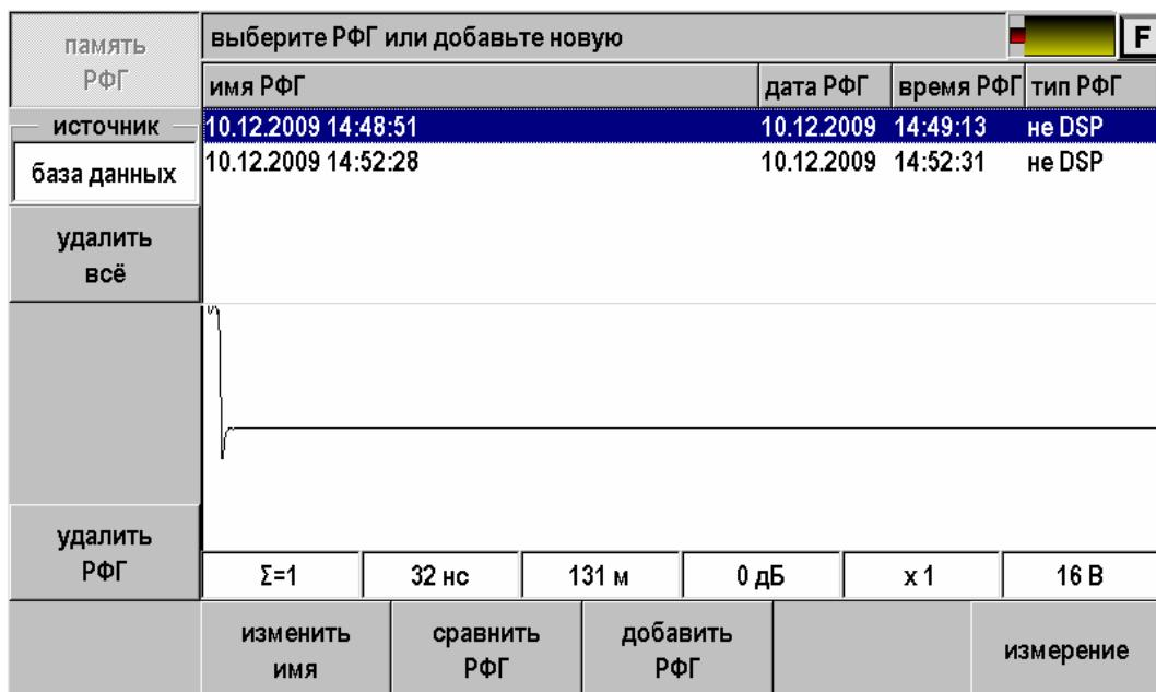
3. Нажать кнопку [Сравнить РФГ]. Прибор перейдет в режим измерений и на экране одновременно появятся текущая рефлектоограмма (зеленого цвета) и рефлектоограмма из памяти (красная). Для лучшего наблюдения рефлектоограммы несколько разнесены по вертикали.
