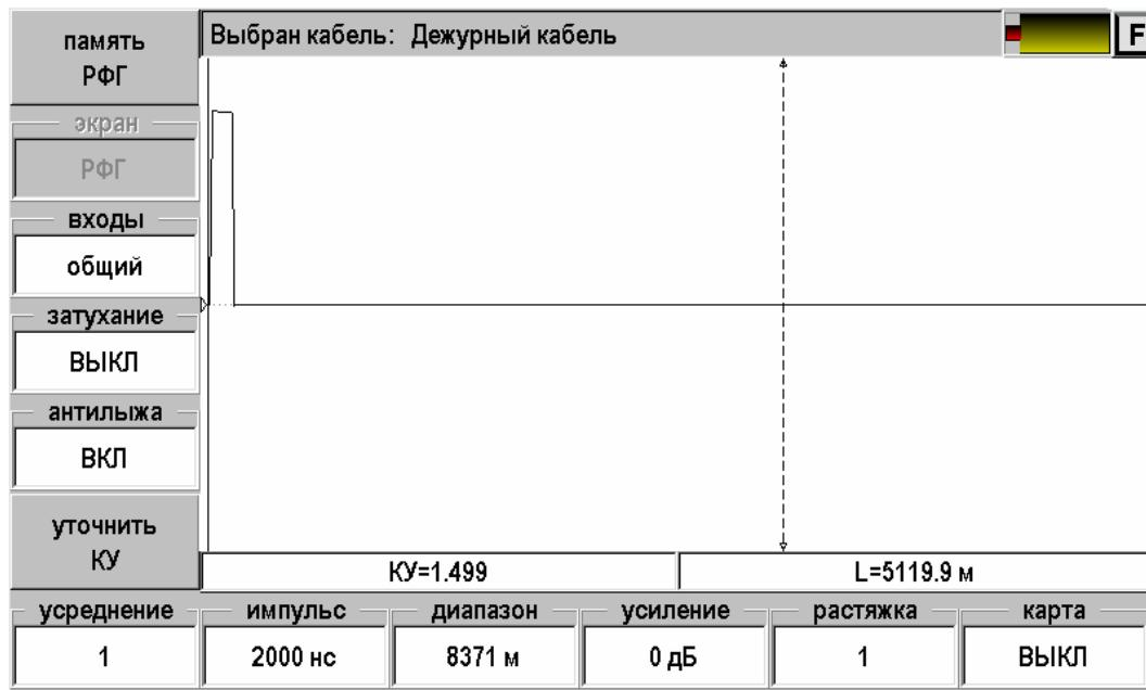
На экране рефлектометра два курсора, между которыми измеряется расстояние на рефлектоGRAMме. Кнопка [OK] делает активным то один, то другой курсор. Активный курсор имеет стрелки. Смещение активного курсора кнопками  $\blacktriangleleft\triangleright$ . Вертикальное смещение рефлектоGRAMмы – кнопки  $\blacktriangle\triangledown$ .
