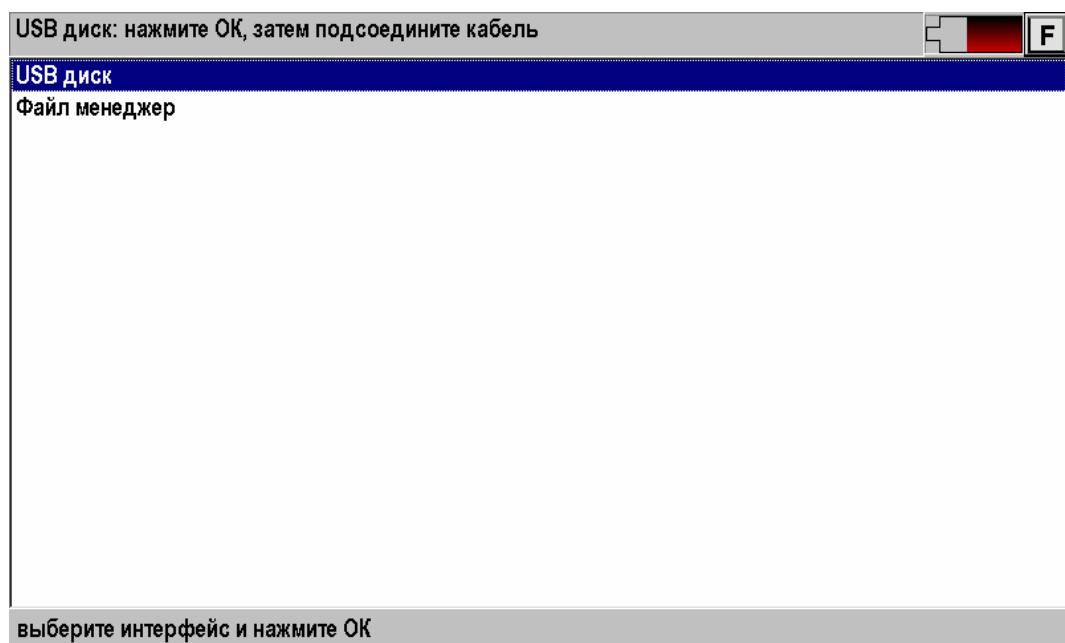
Выберите «USB диск» и нажмите [OK]. Затем подсоедините прибор к ПК через USB кабель. Далее прибор определится как диск на ПК. Обмен данными можно произвести через проводник Windows или подобное программное обеспечение.
