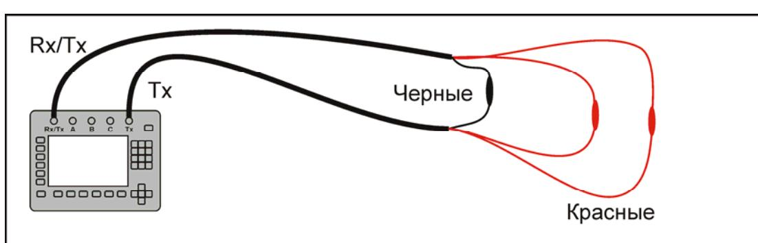
Убедитесь в наличии импульса на экране прибора. Если импульса не наблюдается поменяйте местами красные провода.
