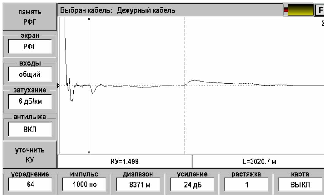
Вид рефлектограммы с исправленной «лыжей» принципиально лучше. Исчезла мертвава область после зондирующего импульса. Слабо различимый дефект кабеля теперь может быть четко локализован.
