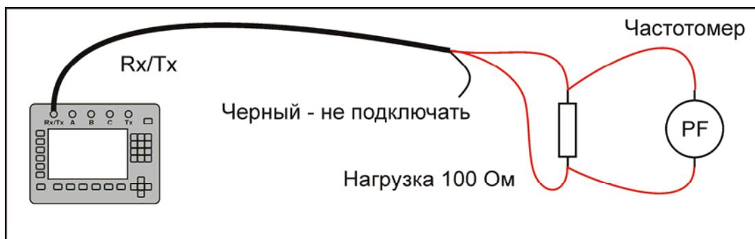
Нажав кнопки «7» и «3», включите режим «КАЛИБРОВОЧНЫЕ МЕТКИ». Проведите измерение частоты следования калибровочных меток с помощью частотомера.
