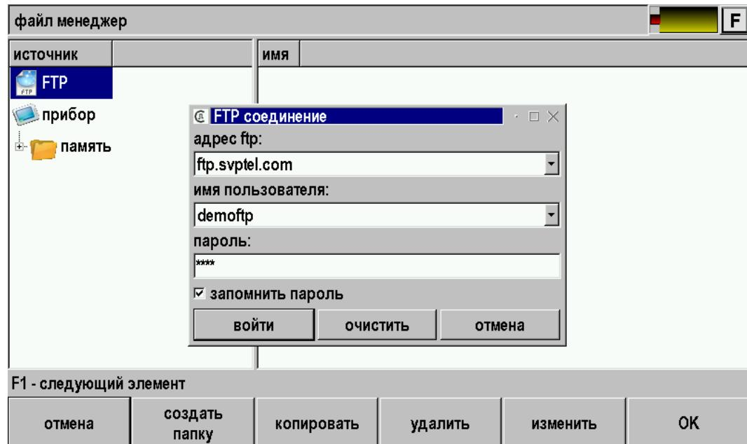
Ввести адрес, имя пользователя и пароль. При успешном соединении с FTP сервером можно работать как с Flash накопителем.
