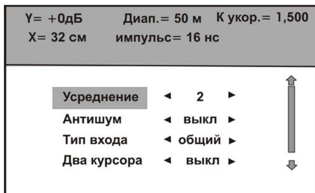
В верхней части экрана выводится информация о текущих настройках рефлектометра, которые задаются с помощью «горячих» клавиш. В нижней части экрана выводятся дополнительные настройки:
