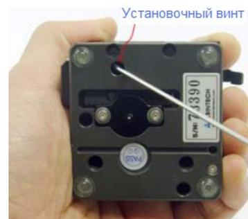
3. Гаечным ключом отверните болт в нижней части штифта лезвия, и выньте его пинцетом из ползунка.
