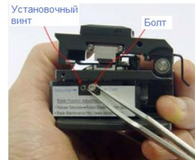
4. Установите лезвие на место, как показано на рисунке. В этот момент будьте особенно осторожны, чтобы не повредить лезвие. Сборка выполняется в порядке, обратном разборке. Надежно затяните установочный винт.
