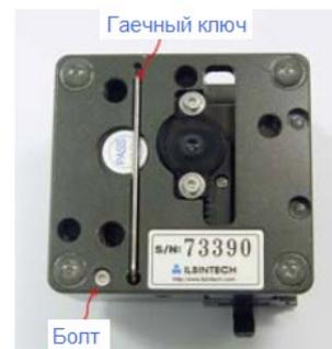
3. Гаечным ключом ослабьте установочный винт (приблизительно на два оборота), как показано на рисунке.
