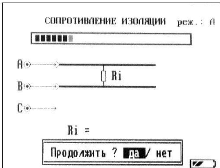
Рисунок 6-14 Измерение сопротивления изоляции
