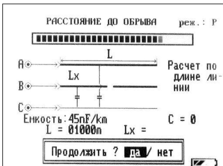
Рисунок 6-19 Определение расстояния до обрыва
