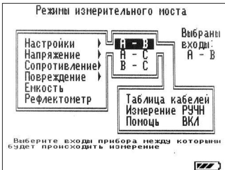
Рисунок 6-13 Выбор способа подключения кабеля к клеммам
