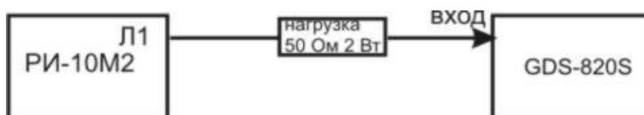
**Рисунок 9-6 Схема проверки параметров зондирующего импульса**
