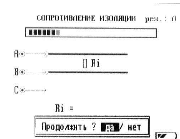
Рисунок 6-14 Измерение сопротивления изоляции
