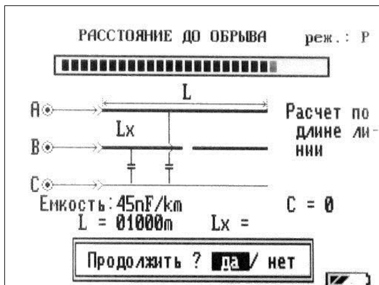
Рисунок 6-19 Определение расстояния до обрыва
