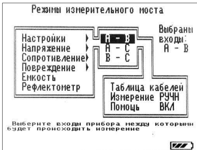
Рисунок 6-13 Выбор способа подключения кабеля к клеммам
