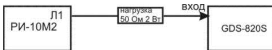
Рисунок 9-6 Схема проверки параметров зондирующего импульса
