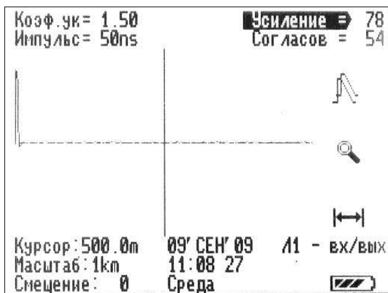
Рисунок 4-2 Вид дисплея в режиме ИЗМЕРЕНИЕ рефлектометра
