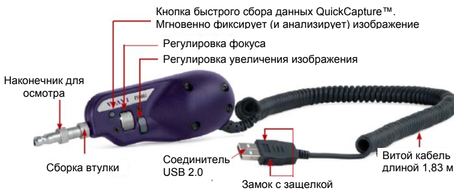
Рис. 14 Компоненты пробника P5000i
