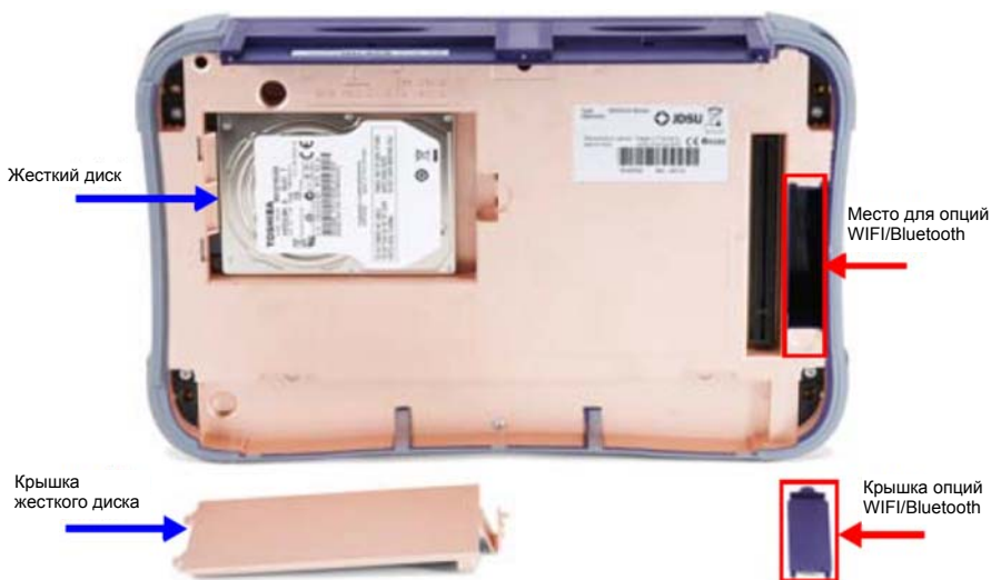
Рис. 88 Местоположение жесткого диска и опций WIFI/Bluetooth
