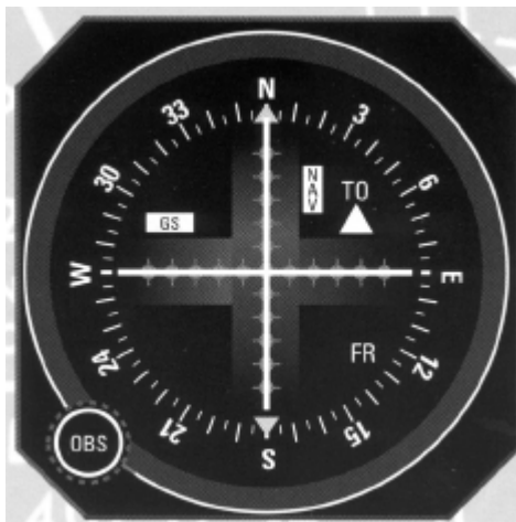
Комбинированное устройство, сочетающее OBS (Всенаправленный селектор пеленга) и CDI (Индикатор девиации по курсу)
