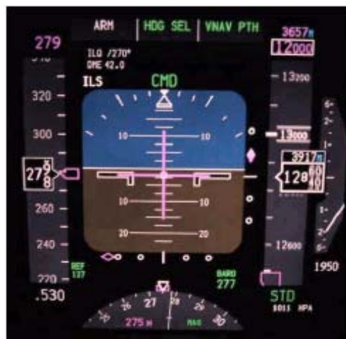
Рисунок 4 – Электронная система индикации полетных данных ILS при девиации 2 1/2 деления
