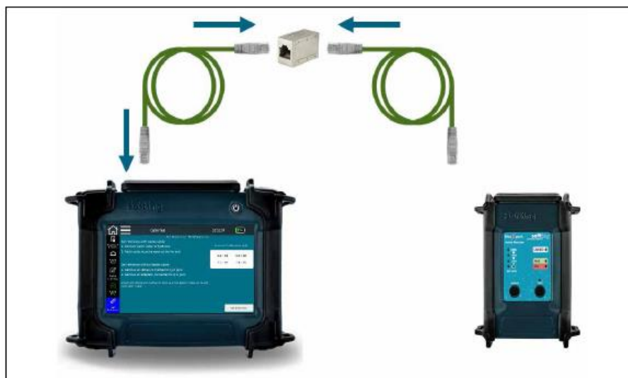
Рисунок 25 – Испытательная установка для настройки точки отсчета
