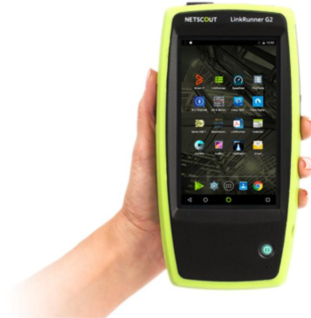
Один из наилучших сетевых тестеров NETSCOUT LinkRunner G2 позволяет ИТ специалистам мгновенно получать важные для них данные. Объединяя возможности тестирования медных и волоконно-оптических сетей Ethernet в операционной системе на базе Android™ OS1, LinkRunner G2 создает прорыв в сфере анализаторов сетей передачи данных, повышая эффективность и продуктивность работы специалистов, ответственных за устранение неисправностей, а также за внедрение и проверку устройств, подключенных к Ethernet сети.
