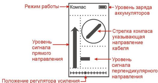
Расположите приемник над трассой как в режиме «КАРТА КАБЕЛЯ+ xxx Гц», т.е. вдоль трассы кабеля в направлении движения от генератора к дальнему концу кабеля. Нажав кнопку **F**, зафиксируйте направление. Теперь стрелка «компаса» будет указывать направление сигнального тока, независимо от ориентации приемника над трассой. Продвигайтесь вдоль кабеля, ориентируясь на максимальное значение сигнала прямого направления и прямое направление на «компасе».
