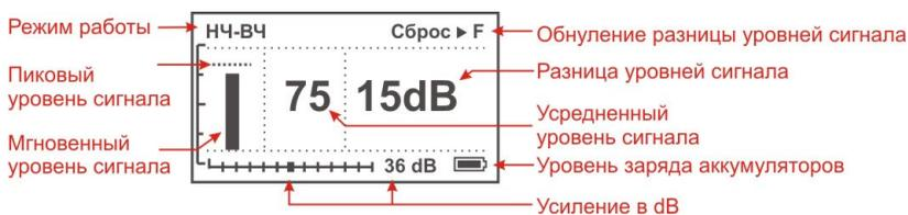
По максимальному уровню сигнала найдите точное положение кабеля. Значение dB на дисплее покажет, есть ли повреждение, 36dB – нет повреждения, меньше – есть. При движении вдоль исправного участка кабеля (трубы) значение будет неизменно, при прохождении места повреждения значение в dB уменьшится. Уменьшение более 4-5dB стоит расценивать как наличие повреждения. Чем более низкое значение достигнуто, тем более низкоомное повреждение присутствует.
