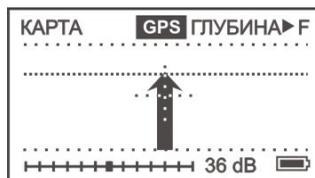
В соответствии с включением «Запись файла» и «GPS» в меню «Настройка», на дисплее могут быть показаны: глубина залегания кабеля, значение сигнала тока, координаты места и номер записи.
