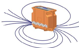
При невозможности подключить генератор контактным способом (кабель недоступен, силовой кабель под напряжением, нет свободных пар в связевом кабеле) подайте сигнал при помощи встроенного индуктора. При таком подключении мощность сигнала, принимаемого трассоискателем, будет значительно меньше, чем в случае контактного подключения.
