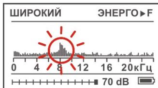
Самые мощные излучения дают силовые кабели с токами промышленной частоты 50Гц. Их поиск как правило проходит успешно. Обычно в спектре присутствуют гармоники, которые зависят от нагрузки. Часто присутствуют сильные нечетные гармоники на частоте 150, 250 Гц... и т.д.
