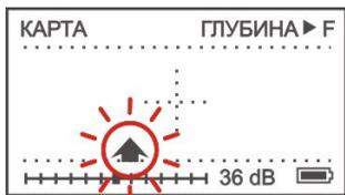
При низком уровне сигнала стрелка указывающая направление, начнет мигать. Если в течение 30 секунд уровень сигнала не возрастет, то заданное направление будет потеряно, при этом индикатор уровня сигнала примет вид полосы. В таком случае вернитесь в положение, когда сигнал хорошо прослушивался, установите приемник над искомой трассой и, нажав **F**, зафиксируйте направление вновь
