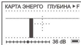
При нахождении точно над кабелем нажмите кнопку **F** для определения глубины залегания.
