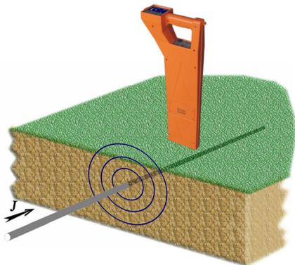
Для точного определения направления залегания трассы поверните приемник из положения максимального сигнала в положение минимального сигнала. В этом случае приемник будет расположен вдоль трассы и укажет ее направление.
