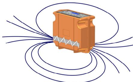
Установите генератор на земле перпендикулярно кабелю или трубе. Включите режим «26 250 Гц - Индуктор», «Пауза» и установите максимальную мощность. При этом встроенный индуктор излучает переменное магнитное поле, которое порождает ток в коммуникации (показано на рисунке). Поле, возбуждаемое током контролируется трассоискателем.
