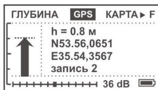
Для получения правильных показаний глубины и значения сигнального тока прибор необходимо расположить точно над трассой, приемник расположить вертикально и под прямым углом к линии. Установите уровень сигнала так, чтобы обеспечить не менее 60-80 единиц на шкале прибора.
