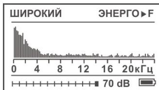
Подземные коммуникации обычно переизлучают радиосигнал в области частот 3-30 кГц.
