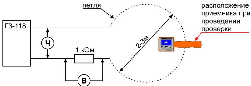
Установите приемник вертикально непосредственно на провод петли, в точку указанную на рисунке.
