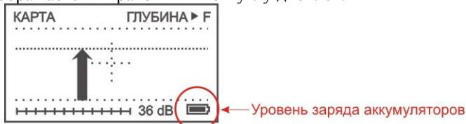
При необходимости заряжайте аккумуляторы с помощью сетевого адаптера, входящего в комплект. При снижении напряжения питания ниже допустимого на экране прибора появится предупреждение о разряде аккумуляторов. При дальнейшем разряде аккумуляторов прибор отключится.
