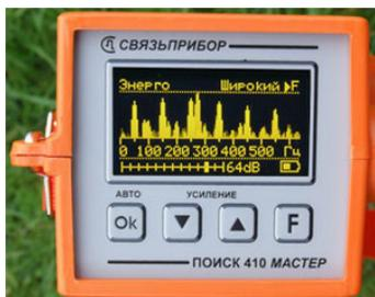
Нагруженные силовые кабели излучают заметный сигнал в области промышленной частоты 50Гц. На спектре помимо сигнала 50Гц видны характерные нечетные гармоники (50-150-250... Гц).
