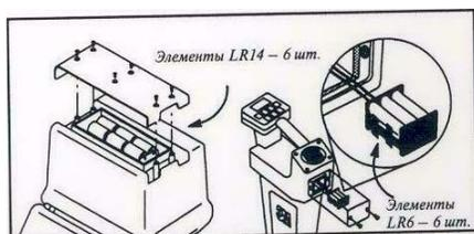
**Внимание!** Нарушение полярности подключения батарей, а также перезарядка использованных элементов питания могут привести к вытеканию электролита и взрыву. При длительном хранении прибора необходимо удалять элементы питания.
