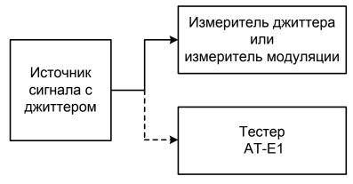
Рис.22.2 Схема для определения погрешности измерения размаха джиттера
