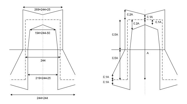
Рис.22.1 Шаблон для импульсов сигнала генератора тестовых последовательностей
