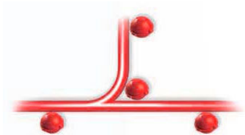
Рисунок 5 – Маркировка ответвлений кабельных трасс
