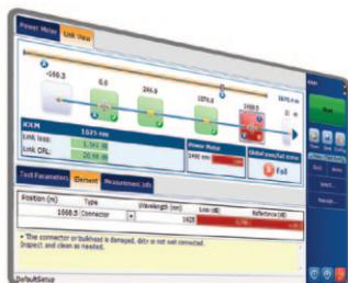
В iOLM применяются автоматизированные многоимпульсные измерения, и используются продвинутые алгоритмы анализа, которые позволяют этому рефлектометрическому приложению получить более подробную информацию по каждому элементу оптической линии. Этот анализ выполняется с помощью всего одного нажатия кнопки, обеспечивая максимальную простоту и позволяя получить анализ линии экспертного уровня.
