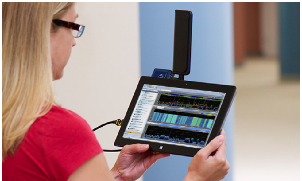
AirMagnet Spectrum ES может сканировать частоты от 698 МГц до 2690 МГц и включает в себя поддержку нескольких технологий.
