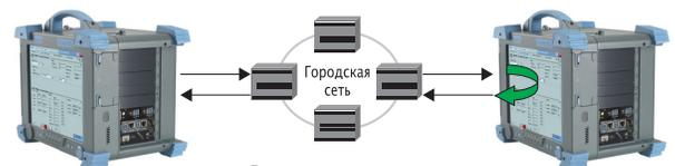
Пример проведения теста с использованием функции «умный шлейф»
