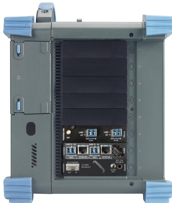
Модуль 10 Гб Ethernet FTB-8510G Packet Blazer устанавливается в прочную, полевую, типа «всё-в-одном», Универсальную Измерительную Платформу FTB-400, компании EXFO. Также на рисунке показана платформа с установленными модулем для тестирования Ethernet FTB-8510 Packet Blazer и модулем для тестирования сетей хранения данных FTB-8520 Packet Blazer SAN (для тестирования Fibre Channel).
