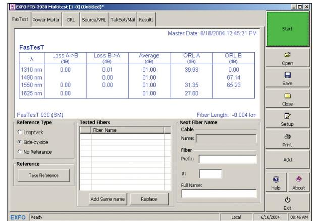
За 10 секунд функция FasTest модуля FTB-3930 проводит измерения значений ORL и потерь на трех длинах волн – включая или 1490 или 1625 нм – на одном выходном порте.
