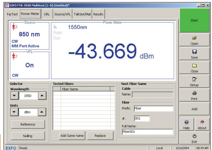
Функции измерителя мощности, источника излучения и дефектоскопа могут быть включены одновременно, и соответствующие данные будут отображаться одновременно.
