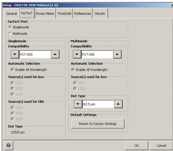
При выполнении измерений FasTest, модуль FTB-3930 может проводить автоматизированные измерения потерь и ORL на трех длинах волн и выполнять измерения длины волокна.
