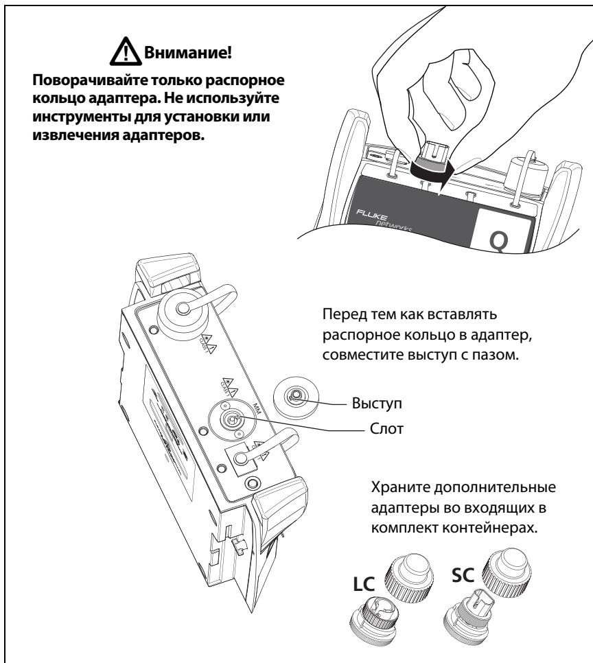
Рис. 50. Извлечение и установка адаптеров разъемов
