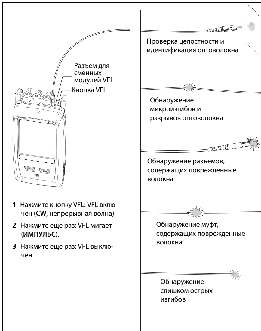
Рис. 71. Использование визуального локатора повреждений
