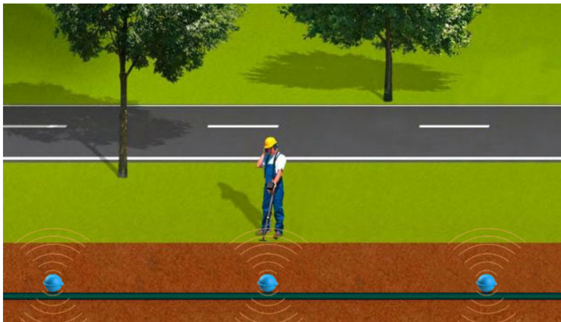
Рисунок 3 - Маркировка и поиск прямолинейных участков неметаллических трубопроводов
