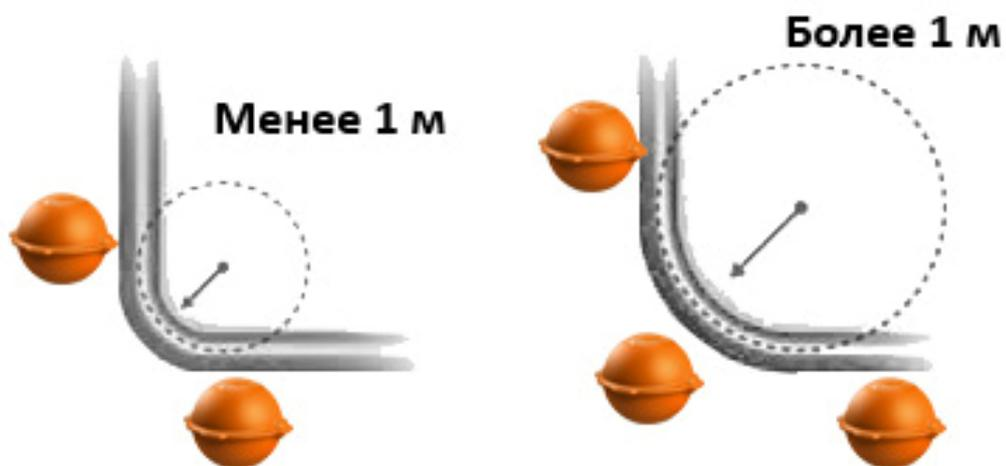
Рисунок 3 – Маркировка мест изменения направления кабельных трасс
