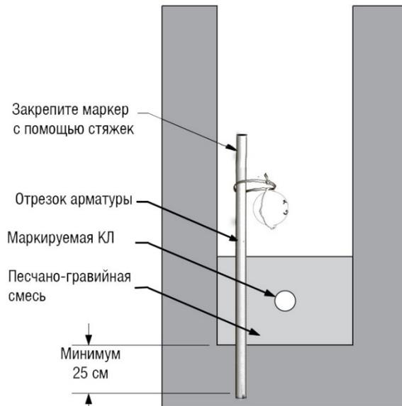
Рисунок 9 – Установка маркера OmniMarker с креплением к вертикальному стержню
