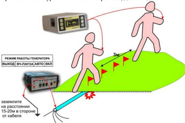
Для уточнения результатов измерители располагаются перпендикулярно кабелю (трубопроводу). Один измеритель с приемником и датчиком в руке располагается непосредственно над кабелем (трубопроводом), второй на расстоянии провода (примерно 3м) с датчиком в руке в стороне от кабеля (трубопровода). Двигаясь вдоль кабеля (трубопровода), наблюдайте за уровнем сигнала. При прохождении повреждения уровень сигнала возрастает, далее падает. Место повреждения соответствует максимальному сигналу.
