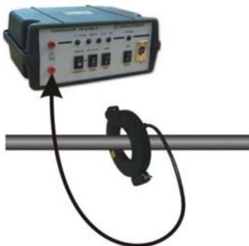
Для передачи более мощного сигнала в кабель используйте индукционные клещи КИ-90<sup>4</sup> (в состав комплекта не входят).
