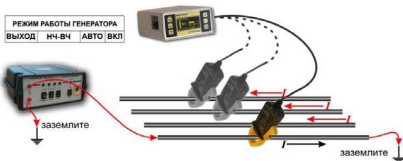
**Метод направления.** Ток в «чужих» кабелях имеет обратное направление. Установите режим работы генератора «ВЧ» или «ВЧ-ПАУЗА», к приемнику подключите клещи-отборник и установите режим работы «ПОИСК ТРАССЫ». Застегните клещи на кабеле в пучке и зафиксируйте направление, нажмите кнопку **F**. Застегните клещи на другом кабеле в таком же положении, как и при фиксации направления.<sup>6</sup> Если направление было зафиксировано на «чужом» кабеле, то только
