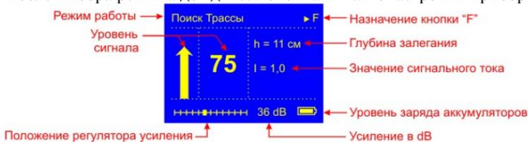
Выберите направление движения от генератора к дальнему концу кабеля. Нажав кнопку **[F]**, зафиксируйте направление.
