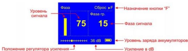
По максимальному уровню сигнала найдите точное положение кабеля. Обнулите фазу сигнала, нажав **F**. При движении вдоль трассы могут «набегать» отрицательные показания. Их следует обнулять (точно над кабелем).
