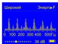
Режим позволяет проводить трассировку скрытой проводки, находящейся под напряжением. Максимум спектра приходится на 50 Гц. В спектре также присутствуют гармоники, которые зависят от нагрузки. Часто присутствуют сильные нечетные гармоники на частоте 150, 250 Гц... и т.д.
