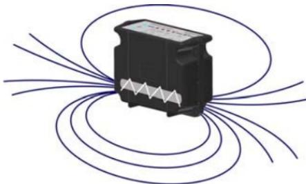
Встроенный индуктор излучает переменное магнитное поле, которое порождает ток в коммуникации (показано на рисунке). Поле, возбуждаемое током, контролируется трассоискателем.
