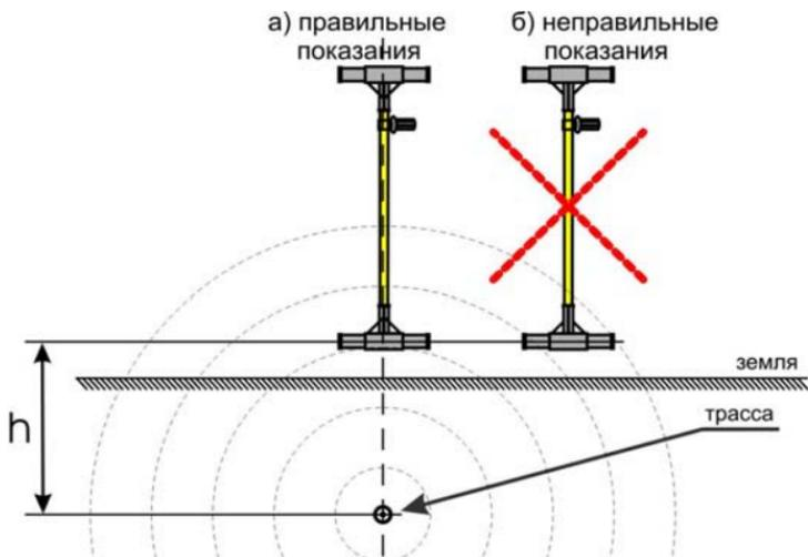
Не проводите определение глубины залегания коммуникации вблизи поворотов, отводов или тройников. Отступите, по крайней мере, 5 м от поворота или отвода для получения максимальной точности.
