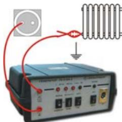
**способ 2:** вывод генератора подключить к жиле скрытой проводки, второй вывод к шине заземления (заземление в розетке, батареи центрального отопления, водопроводной трубе).
