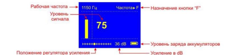
Для изменения частоты работы приемника, нажмите **F**. Выберите изменяемую цифру, нажав **F**, измените значение, нажав **▲** или **▼**. Для возврата нажмите **Ok**. Установленная частота сохраняется в энергонезависимой памяти.
