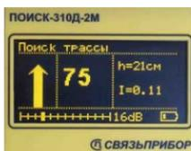
ПРИ ИСПОЛЬЗОВАНИИ ИНДУКТИВНОГО ДАТЧИКА ПОКАЗАНИЯ ГЛУБИНЫ И СИГНАЛЬНОГО ТОКА НЕКОРРЕКТНЫ
