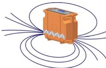
Встроенный индуктор излучает переменное магнитное поле, которое порождает ток в коммуникации (показано на рисунке). Поле, возбуждаемое током, контролируется трассоискателем.
