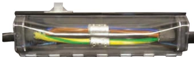
**Тип кабеля:** для неэкранированных кабелей до 5 жил с изоляцией из ПВХ, этиленпропиленовой резины и сшитого полиэтилена. Может устанавливаться на контрольных кабелях. Подходит для соединения экранированных и бронированных кабелей при наличии дополнительных материалов: поводка заземления и пружинных колец (не входят в комплект поставки).
