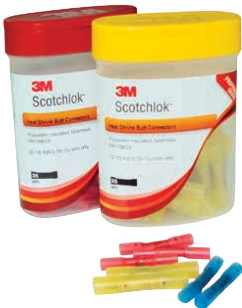
Соединитель с термоусаживаемой оболочкой — это прессуемая гильза из отожженной меди, помещенная в термоусаживаемую изоляционную трубку-оболочку. Путем опрессовки поверх оболочки гильза соединяет два зачищенных медных проводника напряжением до 600 В и восстанавливает электрическую изоляцию.
