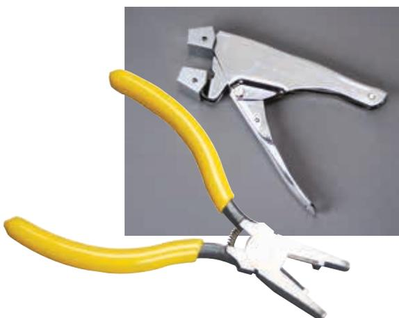
Инструменты позволяют соединить проводники быстро и надежно. Пресс-клещи E9Y имеют параллельнодвигающиеся губки для опрессовки соединителей и остро заточенные режущие кромки для подравнивания жил. Пресс-клещи E9BM имеют регулируемый зазор между губками.
