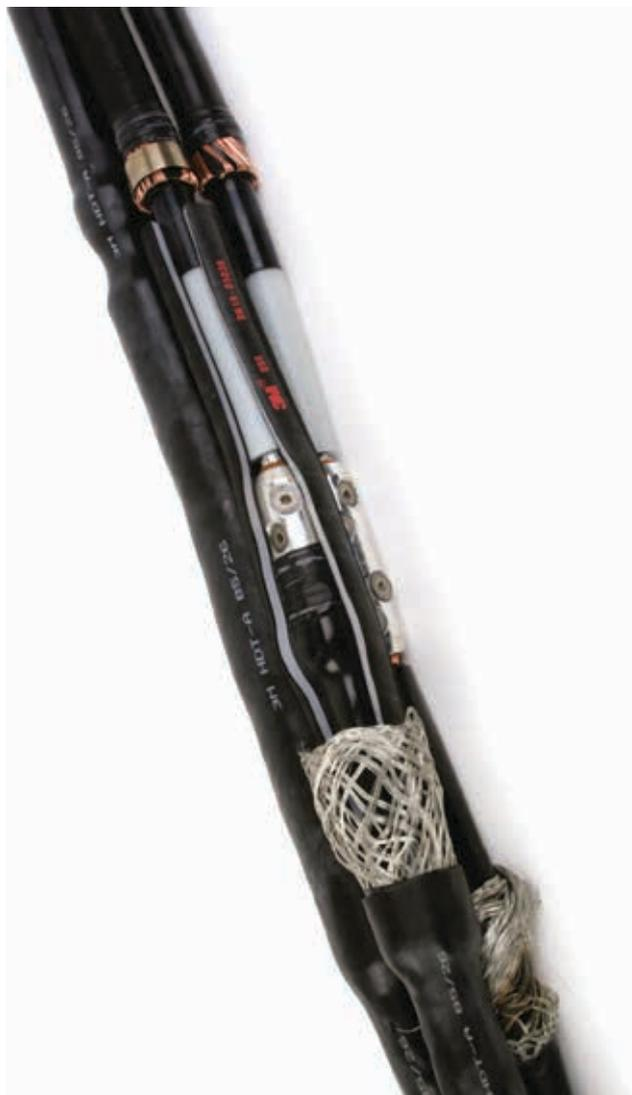
**Тип кабеля:** для соединения трехжильного кабеля с пропитанной бумажной изоляцией в общей свинцовой (алюминиевой) оболочке с тремя одножильными кабелями со сплошной изоляцией и медным проволочным экраном. Муфта может быть установлена на кабель с ленточным медным экраном или экраном из алюмополимерной фольги. Обратитесь к представителям компании 3М для получения дополнительных инструкций.
